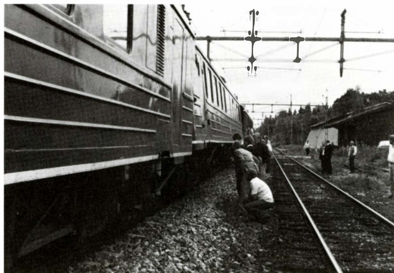
Vognkassen på X15-3 kan tippes op til 6°.
