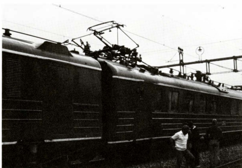
Strømaftageren holder sin stilling i forhold til køreledningen.
