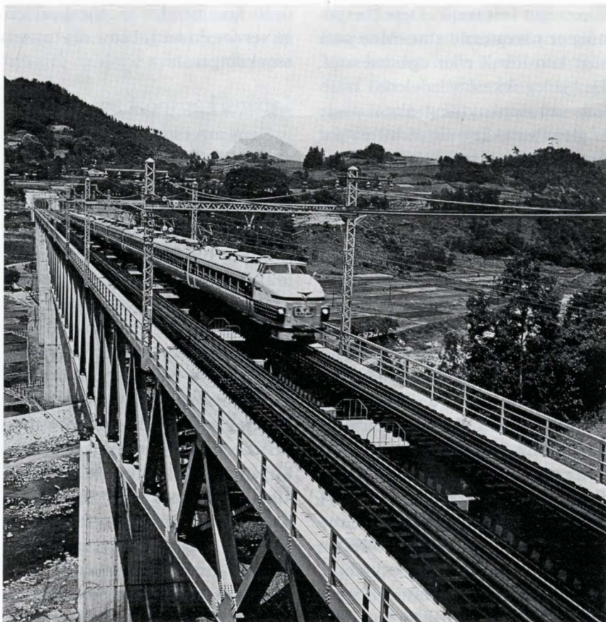
Moderne elektrisk eksprestog bestående af mange, ofte 12 permanent sammenkoblede vogne. Fra endevognenes førerrum er der udsigt i alle retninger. Togene er meget flotte. Airconditioneringsinstallationerne oven på vogtagene pynter dog ikke. Men de er nødvendige i Japan, endda både af hensyn til den hede, fugtige luft i sommertiden og i den nordlige del af landet af hensyn til de til tider meget lave vintertemperaturer.
