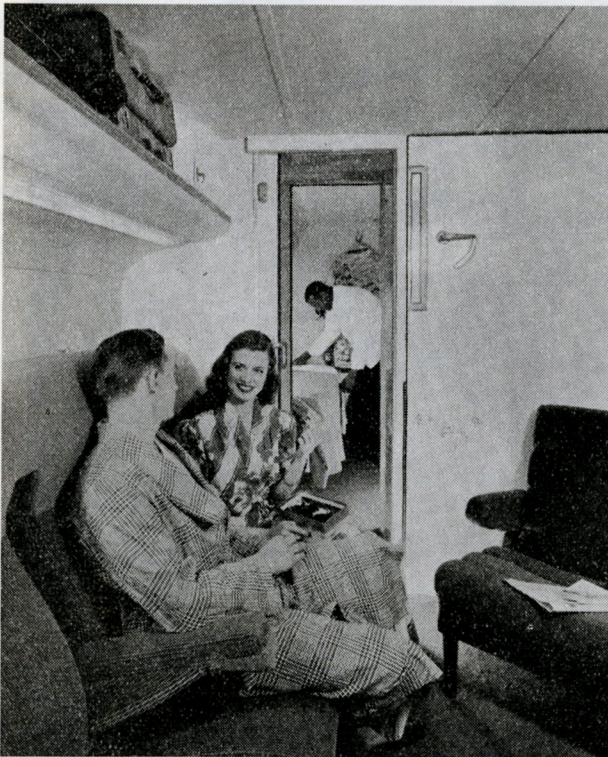
Et dobbelt soveværelse i »Train of Tomorrow«. Sofaen kan omdannes til seng, medens døren bag stolen kan klappes ned og omdannes til den anden seng, hvorunder den sammenfoldelige stol anbringes.
