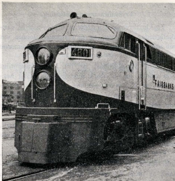
Godstogslokomotiver og lyntogslokomotiver er ganske ens bortset fra udvekslingsforholdene mellem banemotorerne og drivakslerne.
