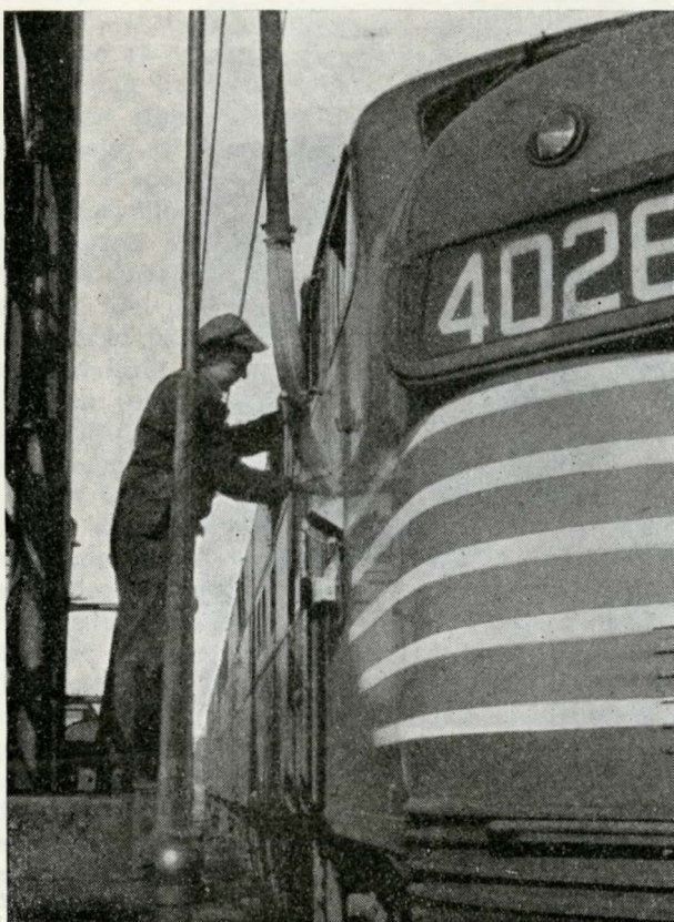
Dieselelektrisk lokomotiv får påfyldt sand fra sandsilo i Harmon.
