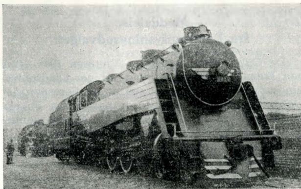
Fig. 25. — Ombygget 2 C 1-Lokomotiv tilhørende Lackawanna-Banen.
