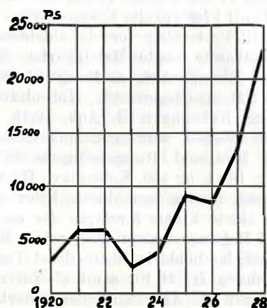
Fig. 3. Borsigs aarlige Produktion af Stempel-dampmaskiner i indiceret Hestekraft.
