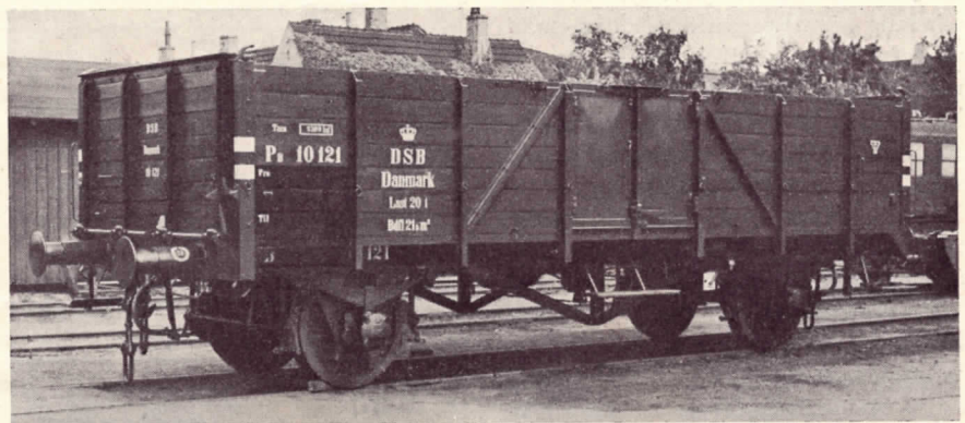
Tegning i \frac{1}{87} . Mål i mm for prototypen. Litra Pb nr. 10.001 - 11.405. Bygget 1942-48. Scandia. Last 20 t. Bundflade 21,5 m 2 . Tara ca. 9400 kg. Trykluftbremse. Håndbremse. Aftagelige endelemme.
