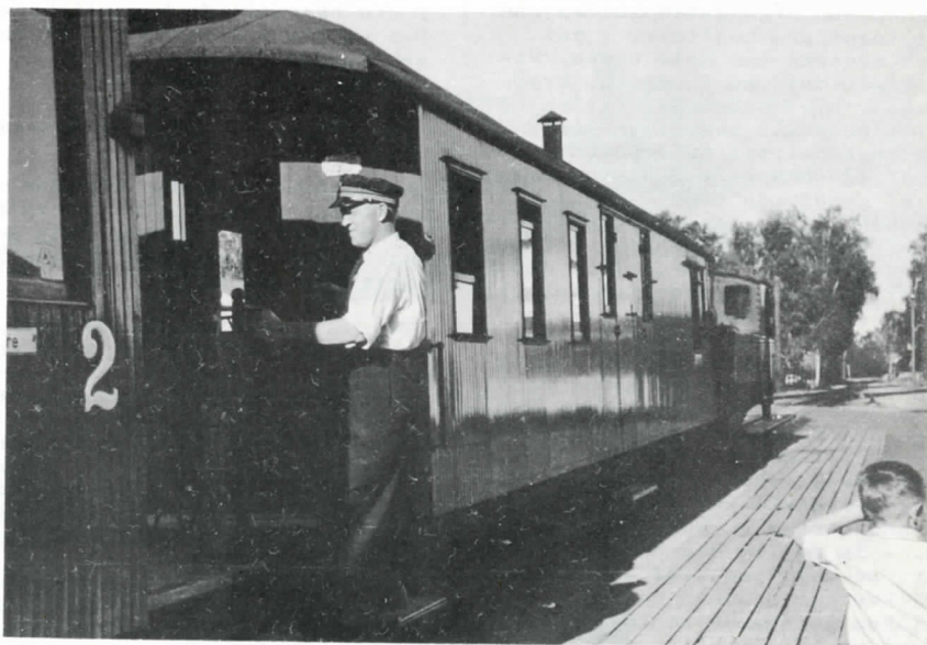
På øverste billede ser vi loket "Höland" og i første vogn vinduet ind til konduktørens kupé. - Det nederste billede viser konduktøren på vej fra den ene vogn til den anden via trinbrædderne, da der ikke findes gangbroer mellem vognene. (fotos ved artiklens forfatter J. Kirchhoff-Jørgensen).
