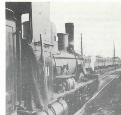
Lav kedel, høj skorsten og ingen sidevinduer
