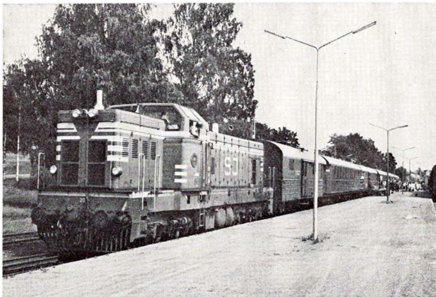
Indtil elektrificeringen fremførtes togene Borlänge-Mora af diesellokomotiver. Her ses SJ T41.201, et NOHAB-bygget GM-lokomotiv fra 1956, i Mora. Foto: -tl-.
