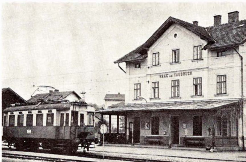
LB BET 24.102 på endestationen Haag am Hausruck i 1974. Motorvognen er bygget af Grazer Waggonfabrik i Østrig i 1931 og ser den dag i dag ud, som da den rullede ud fra fabrikken, bl.a. med de originale træsæder. Minder mest om at køre i en gammel Triangelmotorvogn.
