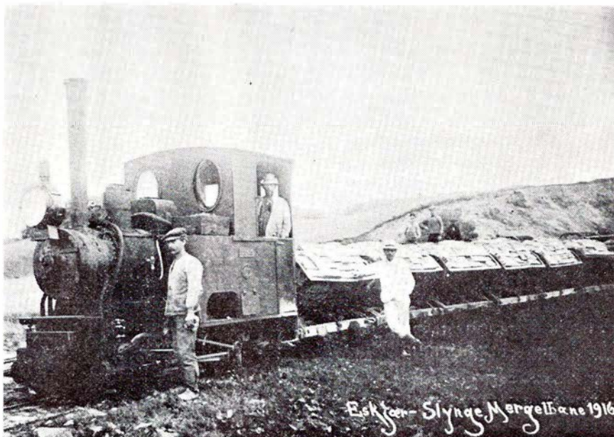
Eskjær-Slyng Mergelbanes damplokomotiv, Krause 3446/1897, fotograferet i 1916, ikke med mergeltog, men med en last mursten.
