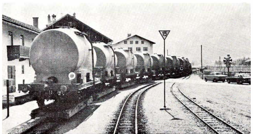
Særtog med specialvogne (normalsporede) forlader Zell am Ziller station, på transportører.
