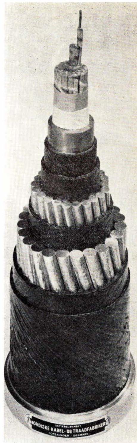
Fig. 3. Fotografi af tele-kablet mellem Rødby F og Pittsgården. 1,6 km landkabel; 3,0 km kystkabel og 16,8 km sokabel.
