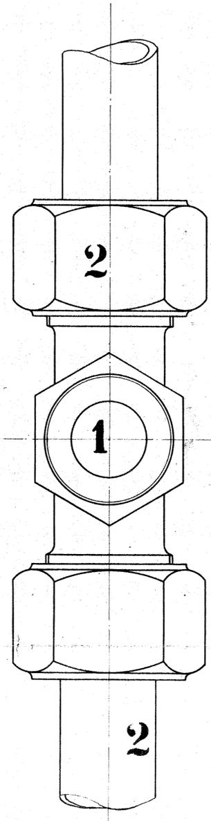
Verschraubungen f. Bremsrohre
