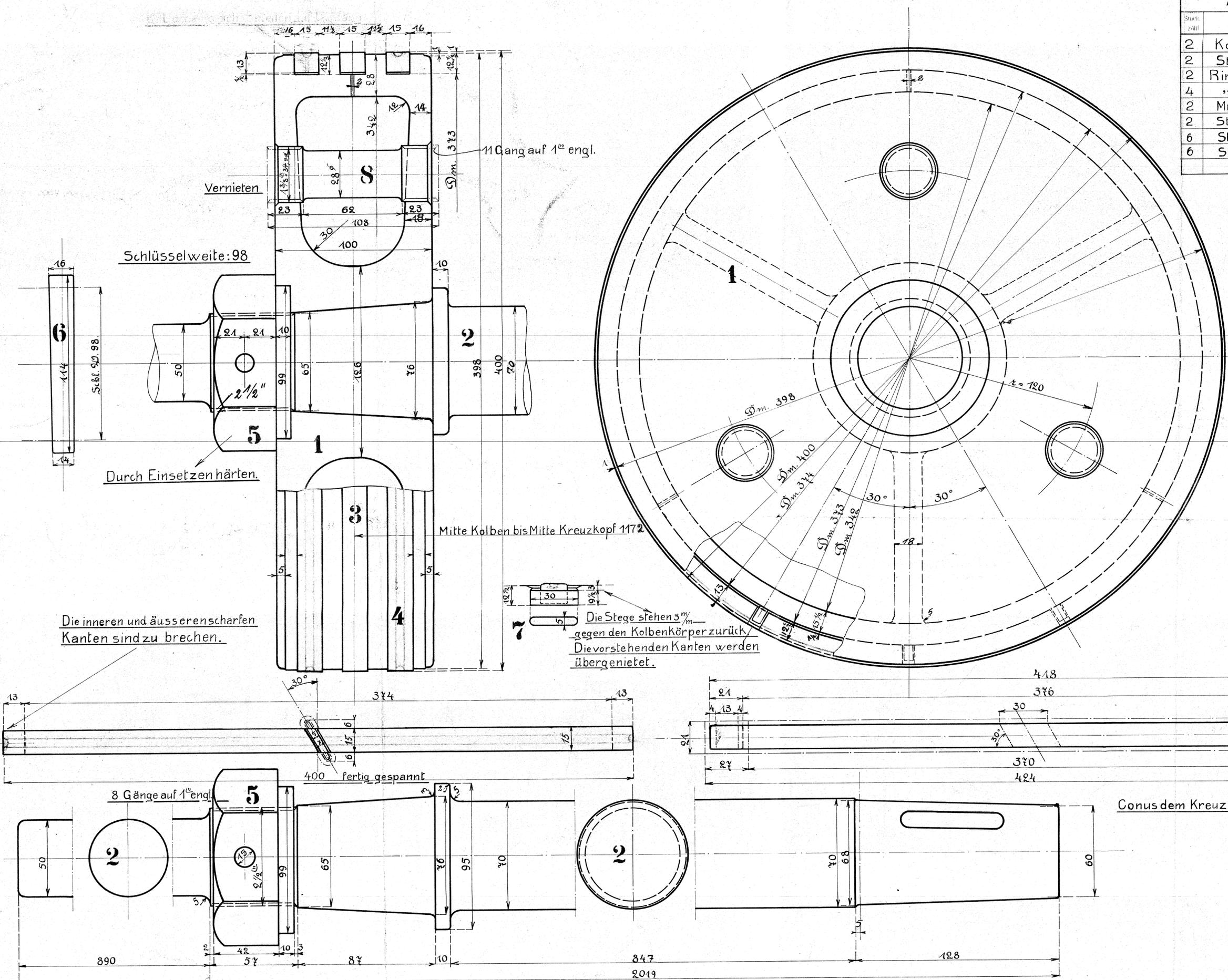
Die Kolbenringe haben im Guss 424 <sup>m</sup>m äusseren Dm. und 370 inneren Dm.. Sie werden auf 418 aussen und 376 innen gedreht und 30 <sup>m</sup>m ausgeschnitten; hierauf mit den Schnittflächen zusammen gelötet und auf 374 <sup>m</sup>m inneren und 400 äusseren Dm. fertig gedreht. Sodann erhalten die Ringe den Ausschnitt von 7 <sup>m</sup>m.
