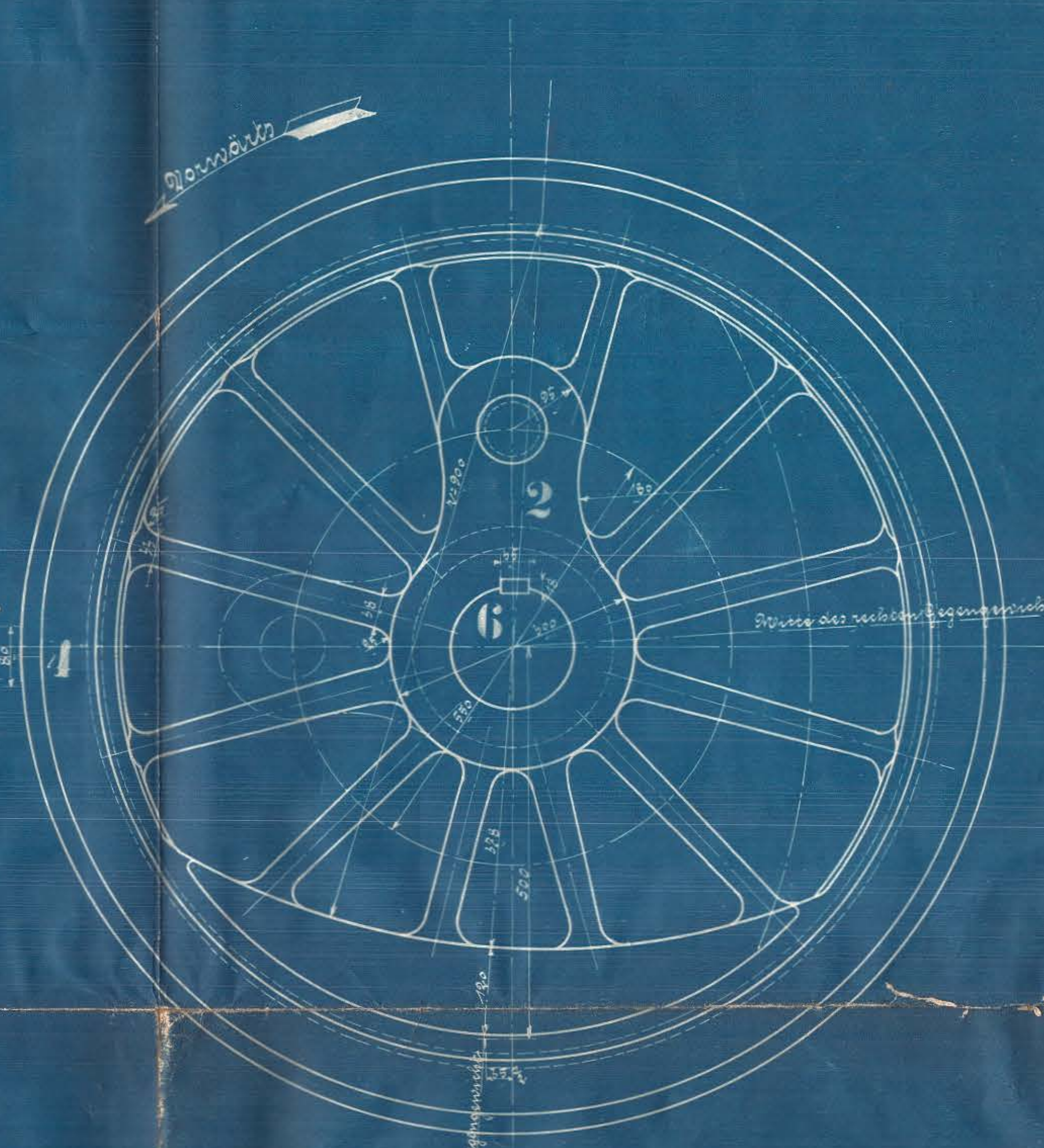
Linkes Trippelrad vom außen gesehen
