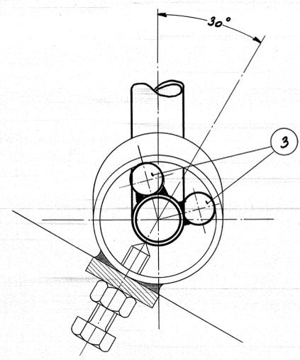
Indvendig rør pos 1 med påsvejst afstandsstykke pos 3 galvaniseres
