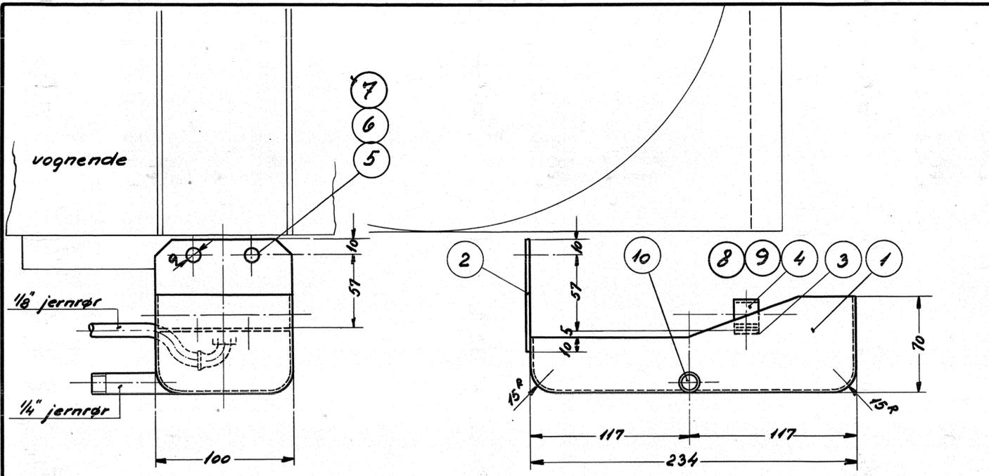
Bakke med endeplade er ens for højre og venstre armatur undtagen 1/4" rørstuds, der skal påsvejses henholdsvis højre og venstre side af bakke som vist.
