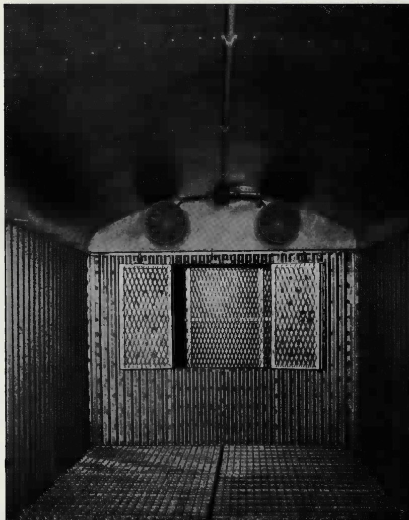
Interiør af den nye INTERFRIGO-kølevogn med stort rumfang, type UIC-ORE 1, forsynet med elektrisk ventilation (På vognens endevæg ses 2 af de elektriske ventilatorer)
