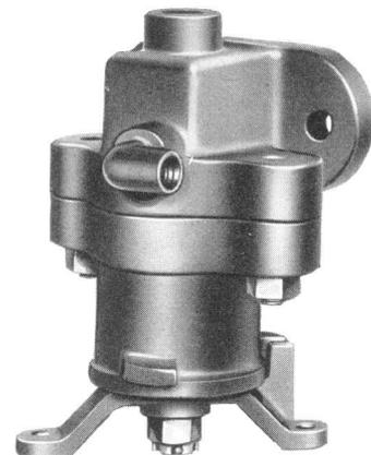
Abb. 27 Ansicht Lösevorrichtung der Kksbr
