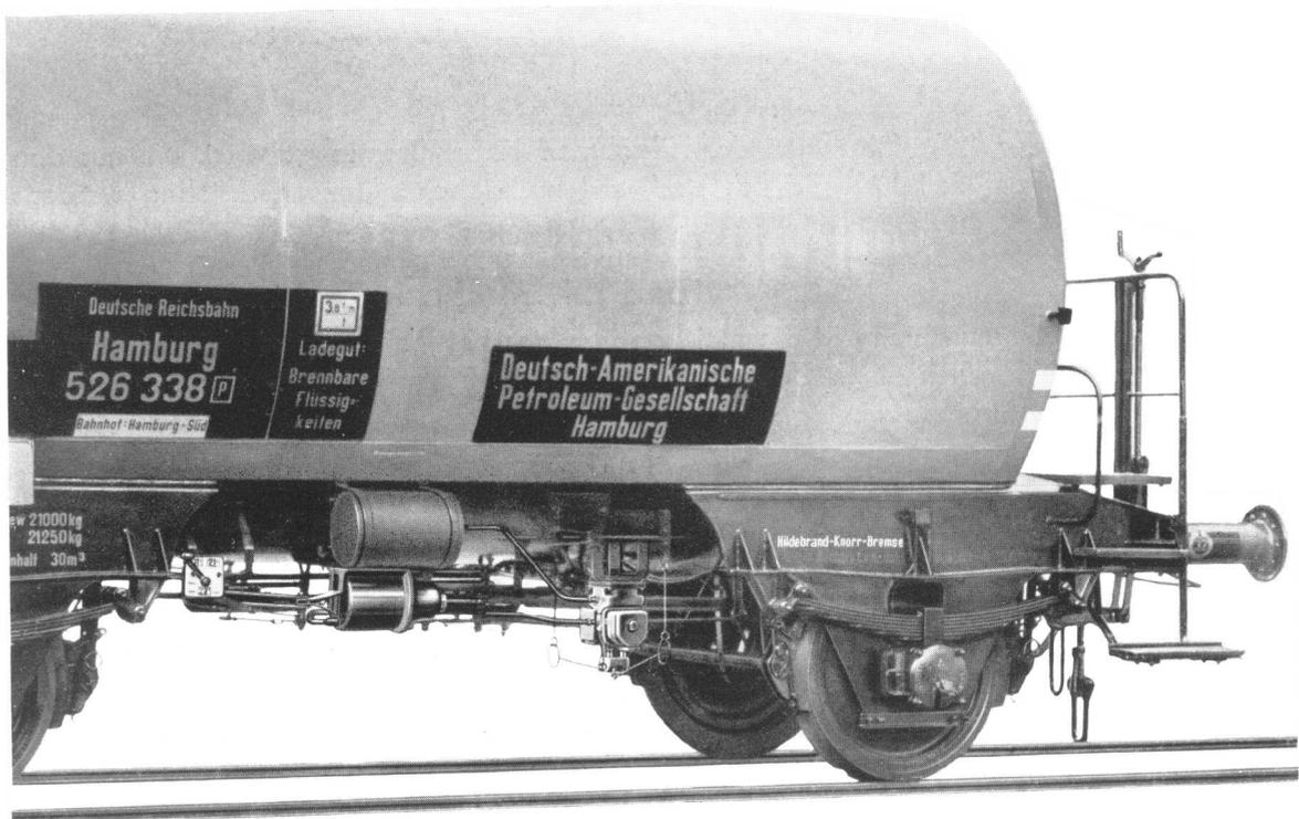
Bild 4 Hikgbr: Steuerventil Hik gl, mechanische Lastabbremmung und Leichtbremszylinder aus Stahl am untergestellfreien Einheits-Leichtkesselwagen „Deutzer Bauart“ von Westwaggon Köln-Deutz
