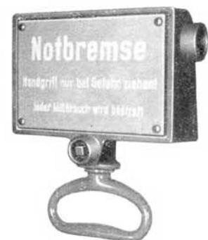
Abb. 34 Notbremszugkasten ZM 4
