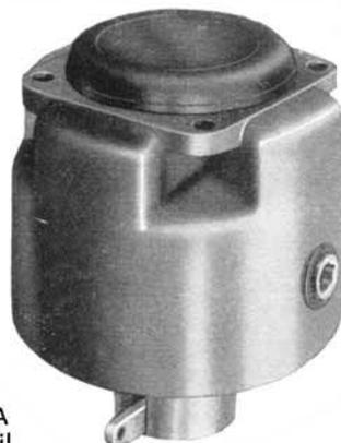
Abb. 11 Steuerkammer A mit Löseventil
